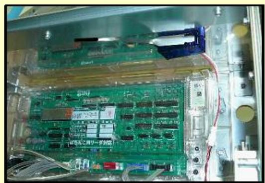
ドアが開けば、呼出ランプ、コンピューター等に不正出力します
