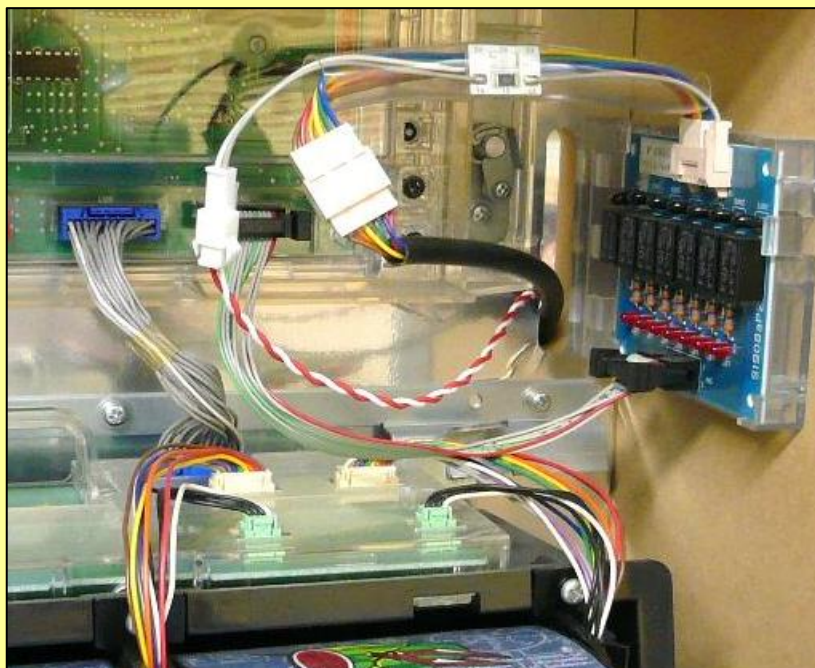
スロット台 情報端子板からの接続写真
